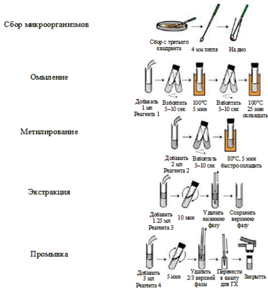
Рисунок М. 3 - Этапы пробоподготовки образца.
